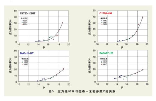
图 5 显示铍铜的剩余应力与 铍铜合金拉森-米勒参数 P 之间的关系。从这一曲线可 以看出 P 所对应的剩余应力, 用于估算剩余张力所对应的 设计需要的温度与时间的结 合点。
