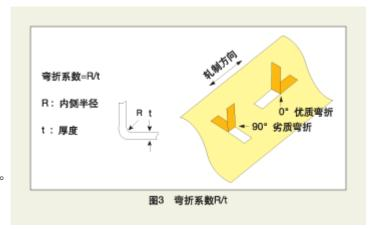
NGK 铍铜家族的弯折系数表示如下表  $1\sim3$ 。弯折系数根据厚度不同而不同,厚度越薄 R/t 的数值变小的倾向越大。是厚度 0.15mm 的 R/t 数值。
